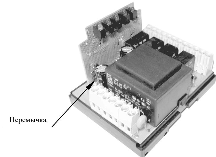
Рис. 3. Расположение перемычки переключения порога срабатывания
