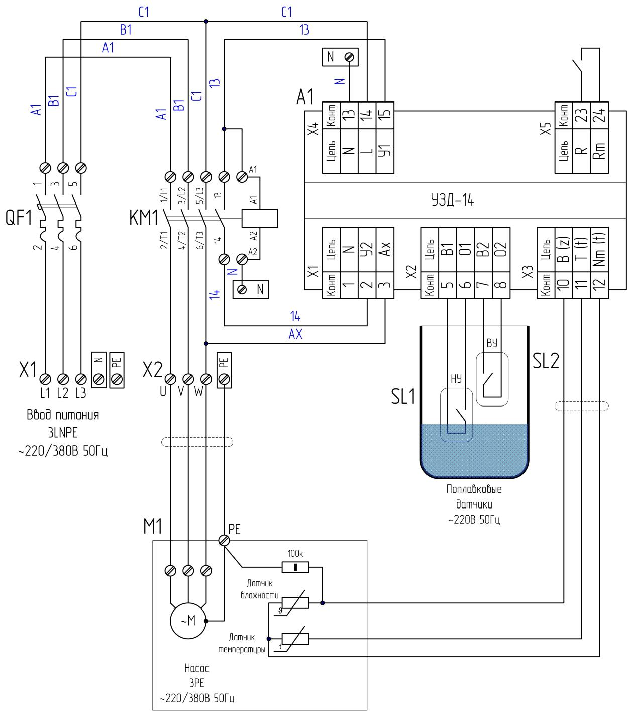
Рисунок 2 - Рекомендуемая схема включения
