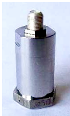
Рис. 1. Внешний вид датчика вибрации ВД03А.
