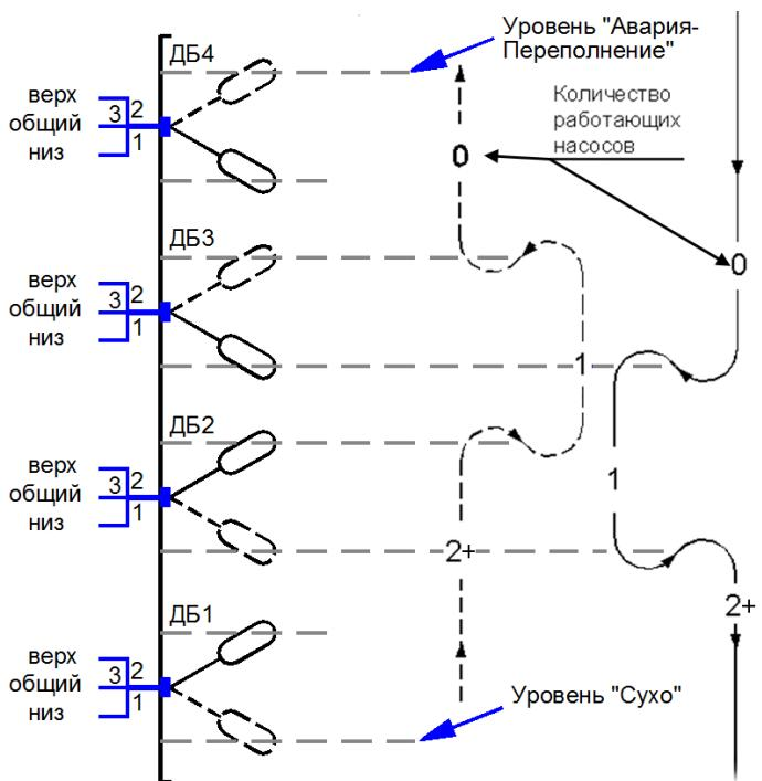
Рисунок 5.2 Работа насосов при использовании двухуровневых датчиков в режиме наполнения
