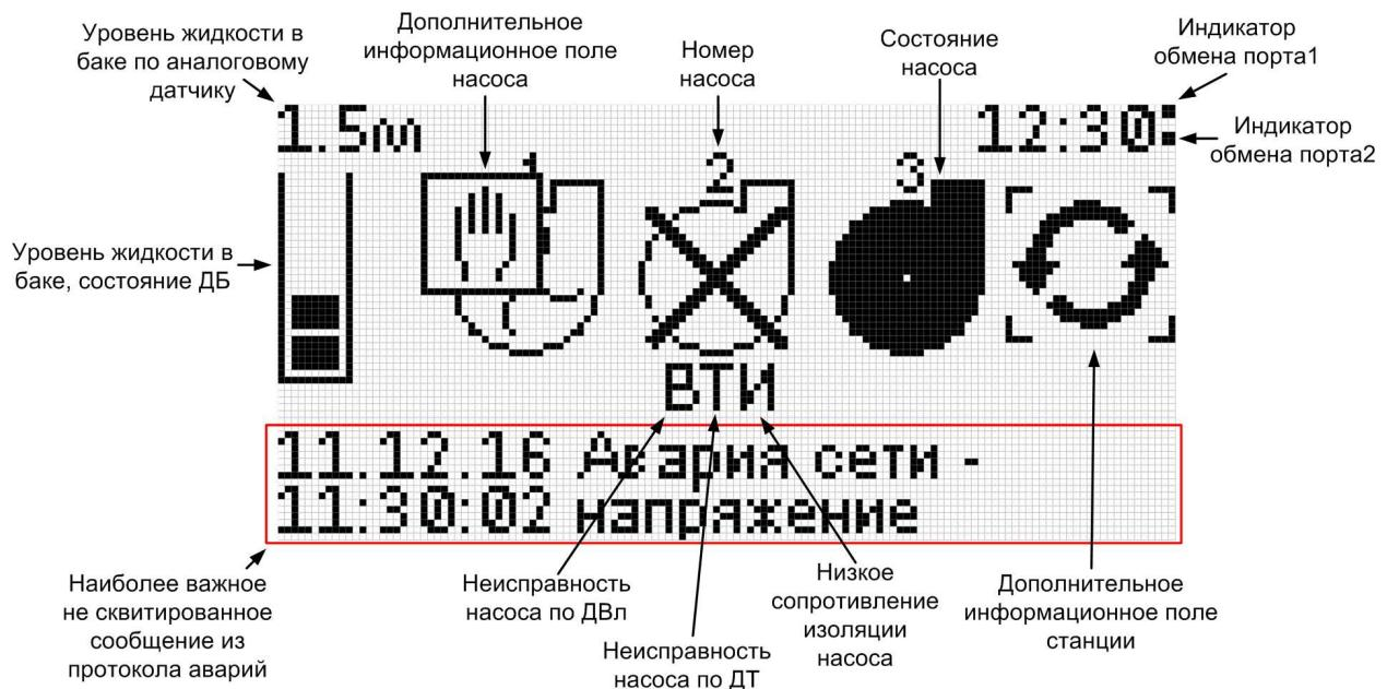
Рисунок 7 Базовый экран (при работе с тремя насосами)
