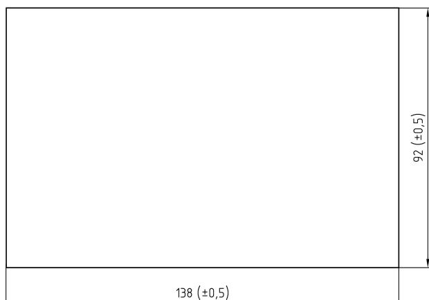
Рисунок 9 Требуемые размеры окна для установки контроллера
