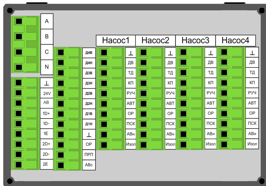
Рисунок 2 Расположение клемм на задней панели
