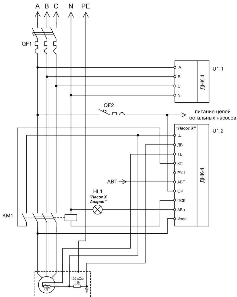
Рисунок 16.1 Типовая схема подключения насоса к ДНК-4
