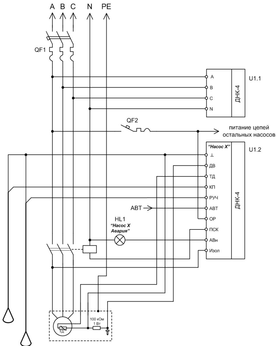
Рисунок 16.3 Типовая схема подключения дренажного насоса к ДНК-4
