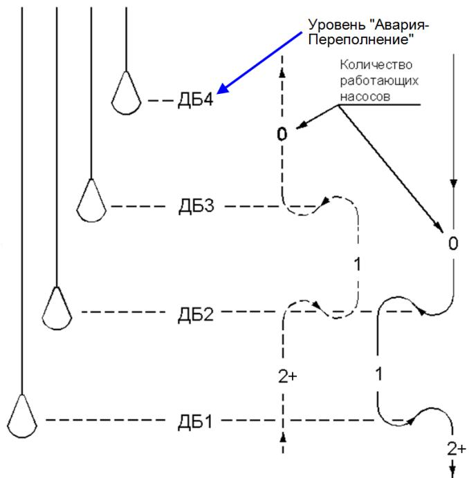
Рисунок 4.2 Работа насосов при использовании одноуровневых датчиков в режиме наполнения
